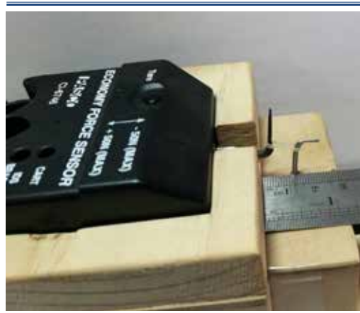
Figura 2. Dinamómetro inserto en plataforma compuesta por un gancho para el apoyo de los elásticos sobre una regla milimetrada.
