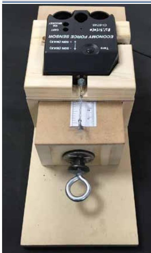
Figura 5. Sensor de fuerza PASCO CI-6746, adaptado para la medición de fuerza de cadenas elásticas.
