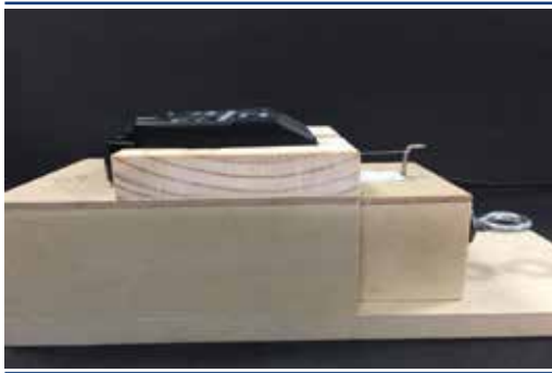
Figura 6. Sensor de fuerza PASCO CI-6746, adaptado para la medición de fuerza de cadenas elastoméricas.
