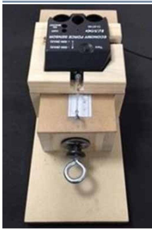
Figura 4. Sensor de fuerza PASCO CI-6746, adaptado para la medición de fuerza de resortes de Níquel-Titanio.
